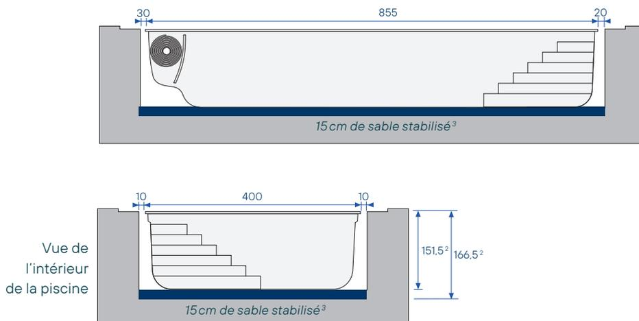
Attention : les mesures de terrassement ne tiennent pas compte des décaissements nécessaires aux margelles.
