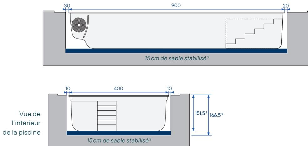
Attention : les mesures de terrassement ne tiennent pas compte des décaissements nécessaires aux margelles.
